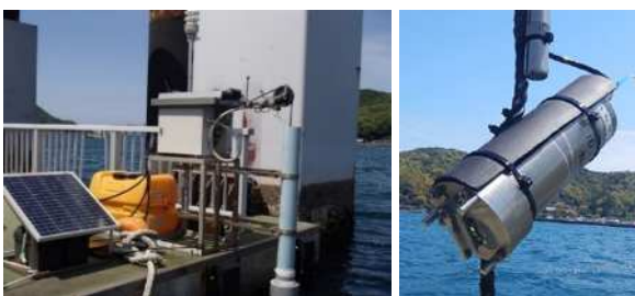
写真2 佐伯湾鶴見沿岸で設置している赤潮観測機器 左:自動昇降式赤潮観測装置(環境システム株) 右:有害プランクトン検出センサー(HAIセンサー)(JFEアドバンテック(株))
